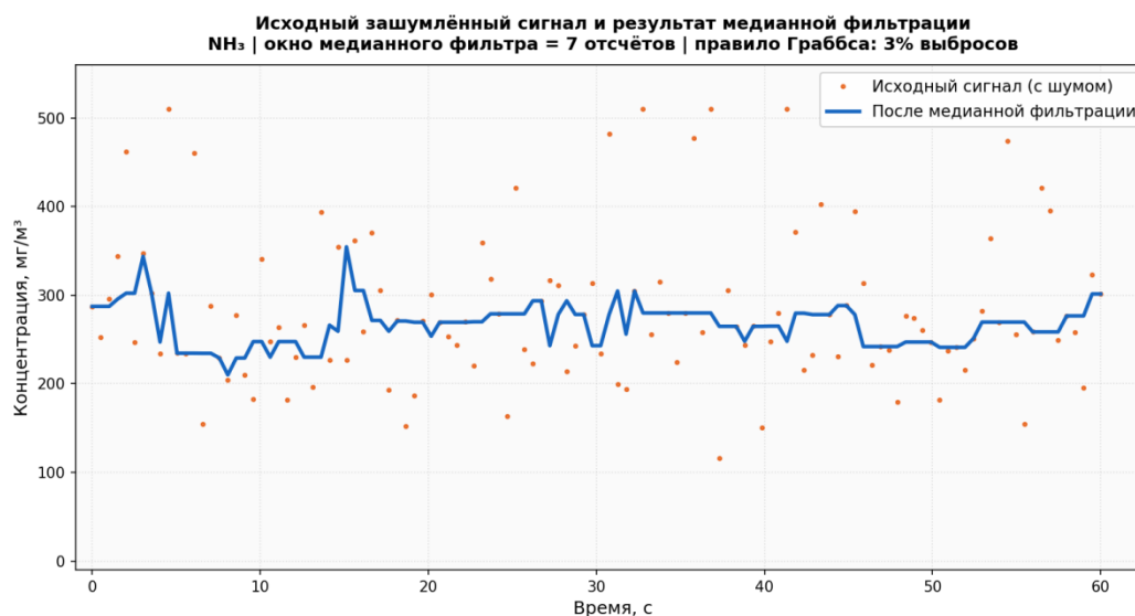
Рис. 1. Исходный зашумленный сигнал и результат медианной фильтрации
