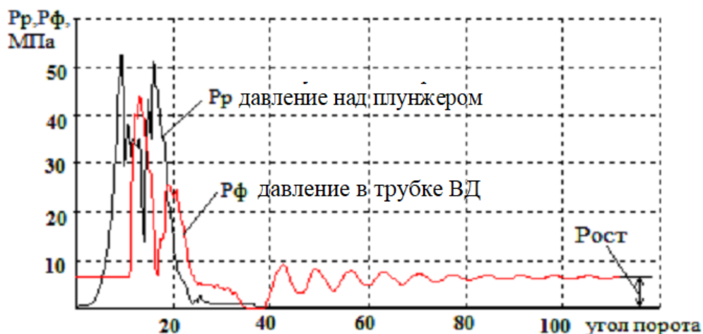
Рис. 4. Давления топлива в ТНВД и трубопроводе ВД
