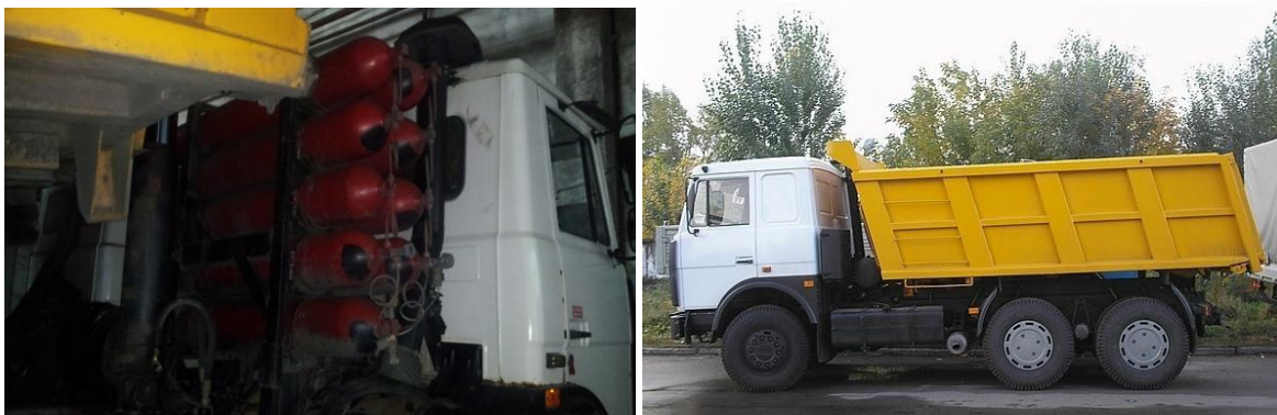
Рис. 2. Расположение баллонов с газом на автомобиле МАЗ-551605-271 (газодизельная система)
