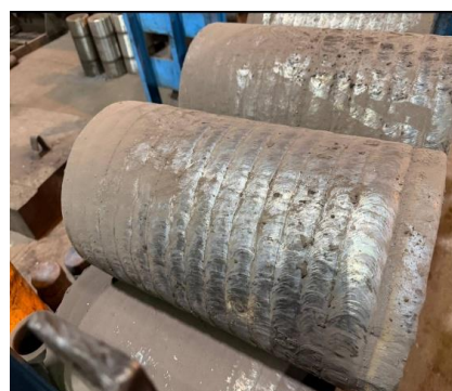
Рис. 2. Бандаж ролика МНЛЗ после наплавки до механической обработки
