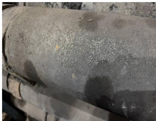
Рис. 1. Поверхность бандаж после эксплуатации: сетка разгара и следы износа
