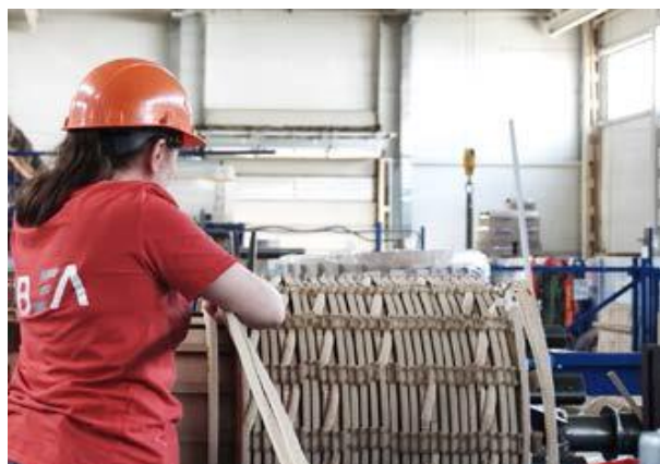
Рис. 6. Процесс намотки катушечных групп в обмотке ВН
