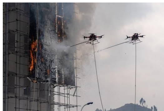
Рис. 3. БПЛА в процессе пожаротушения многоэтажного здания
