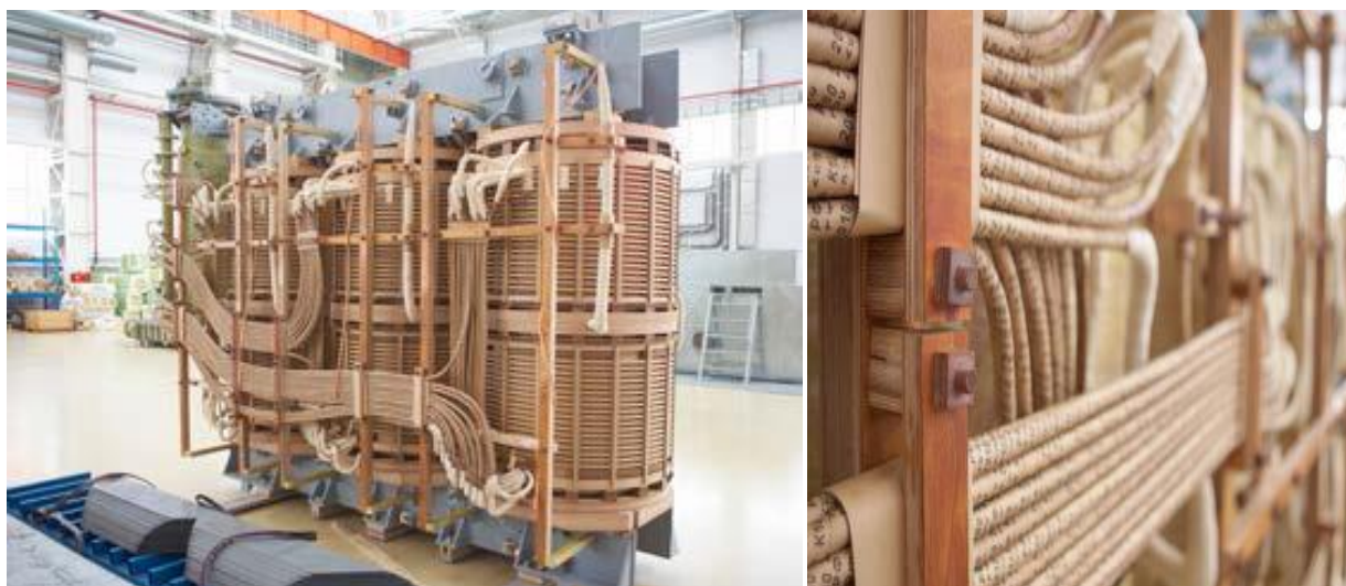
Рис. 8. Активная часть СТ после процесса сборки и сушки
