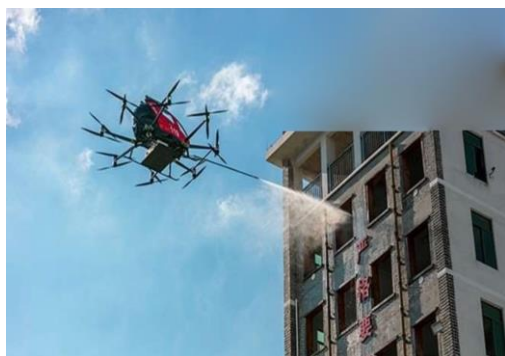
Рис. 3. БПЛА в процессе пожаротушения многоэтажного здания
