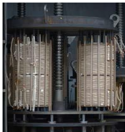
Рис. 5. Обмотка ВН в сборе в горизонтальном положении
