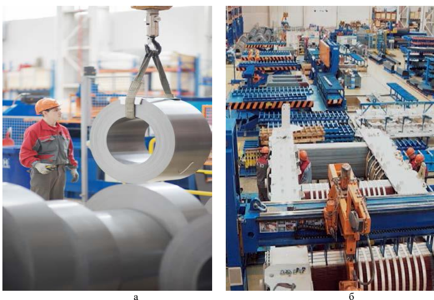
Рис. 3. Доставка электротехнической стали в рулонах (а) на участок по сборке магнитных систем СТ (б) предприятия АО «Группа «СВЭЛ»
