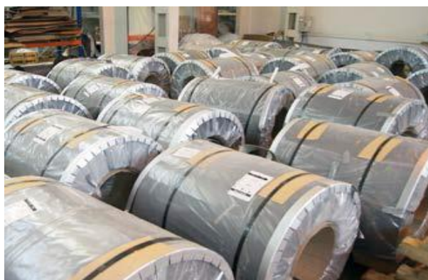
Рис. 2. Поставка электротехнической стали в рулонах на склад завода-изготовителя СТ
