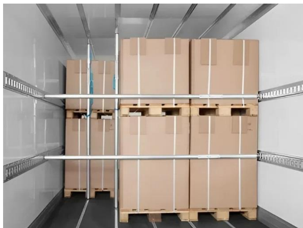
Рис. 2. Крепление грузов с использованием распорной фиксации
