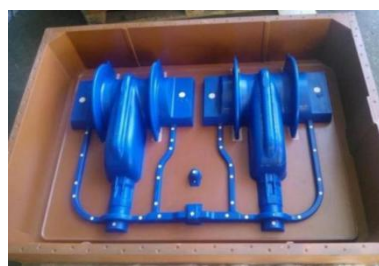
Рис. 6. Модельный ящик с перфорированной модельной плитой
