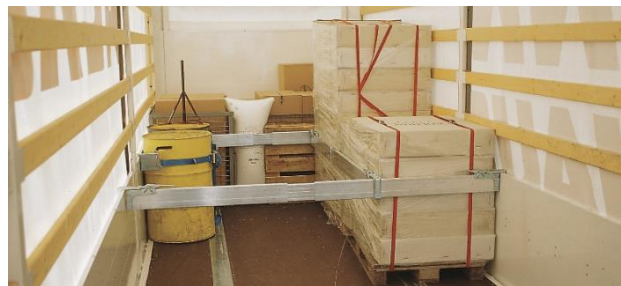
Рис. 3. Фиксация грузов с использованием распорочных планок, пневмооблочки и стреппинг-ленты
