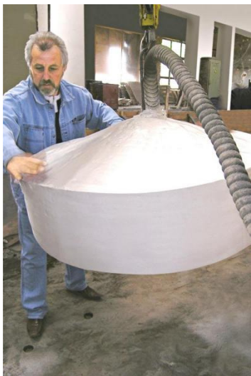
Рис. 13. Нестандартная безопочная полуформа с использованием гибких перфорированных трубок
