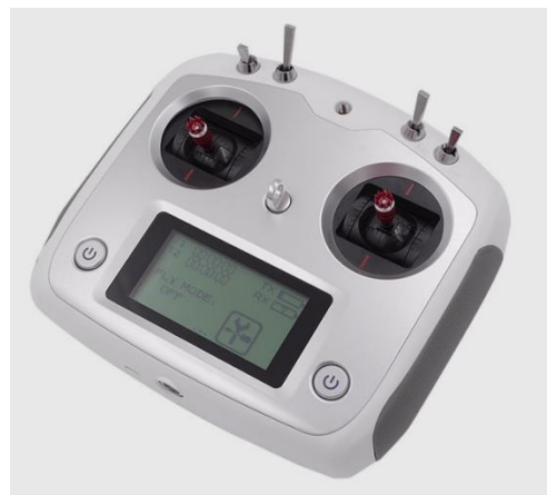
б – пульт управления Flysky 10CH 2,4ГГц FlySky FS-i6S
