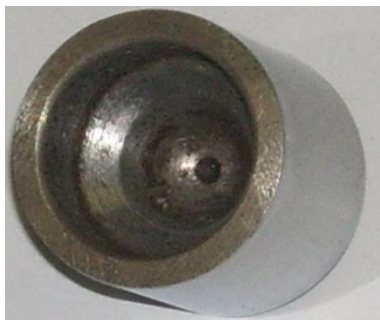
Рис. 5. Фото детали «наконечник», полученной из порошковой меди
