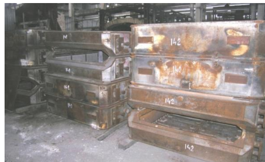
Рис. 1. Конструкция опок при вертикальном разрезе форм
