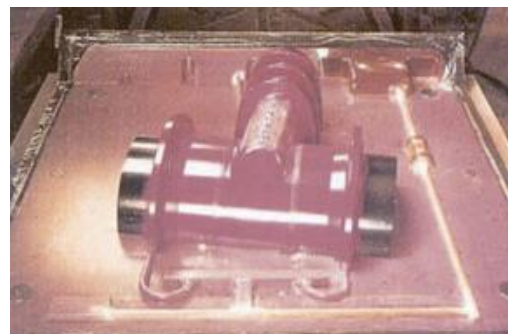
Рис. 2. Подмодельная плита для вертикального разреза форм
