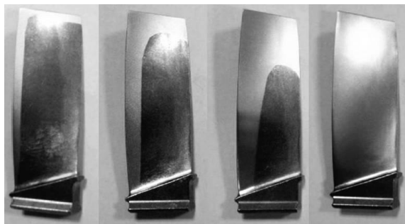
Рис. 1. Пример последовательного наложения фигурных нанослоев нитрид титана на перо лопатки компрессора газотурбинного двигателя ТВ3-117
