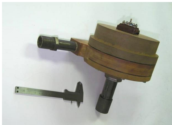
Рис. 4. Насос со спиральным отводом жидкости ЦНС-1
