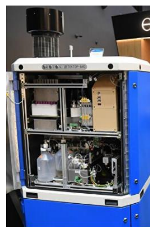
Рис. 4. Изображение устройства «Детектор-Био» с открытой боковой крышкой
