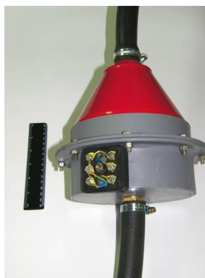
Рис. 5. Насос с соосным отводом жидкости ЦНО-1
