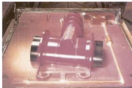
Рис. 1. Двухплоскостная под модельная плита с моделью для формы с вертикальным разъемом
