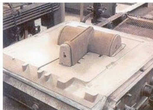
Рис. 2. Полуформа в сборе для вертикального разреза форм
