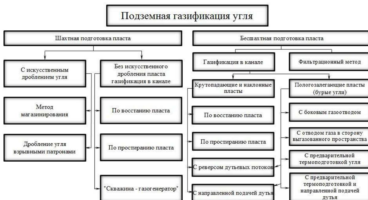
Рис.1. Схема, отражающая развитие ПГУ в XX в. (по Е.В. Крейнину)
