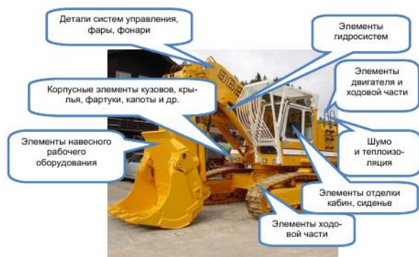
Рис. 2. Применение КМ в конструкциях дорожно-строительных машин
