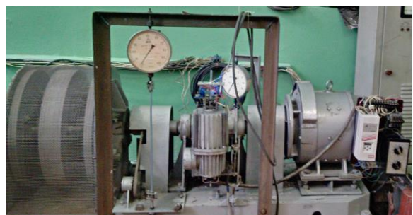
Рис. 2. Тормоз на качающейся раме и электродвигатель постоянного тока, соединенный с валом тормозного шкива упругой муфтой
