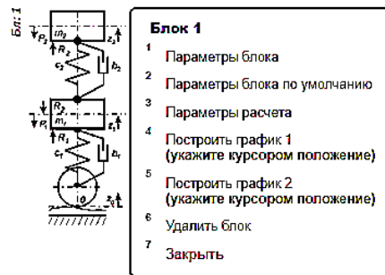
Рис. 3. Контекстное меню для двух масс и возмущающего воздействия (упрощенная модель вертикальных колебаний рельсовых экипажей с двухъярусным подвешиванием)
