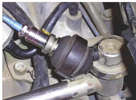
Рис. 5. Размещение датчика пульсаций на топливной рампе двигателя
