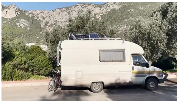
Рис. 5. Автофургон, оснащенный солнечными панелями
