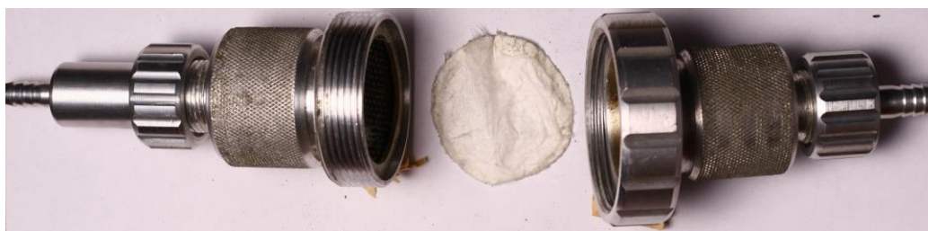
Рис. 3. Патрон для использования фильтра типа АФА диаметром 10 мм
