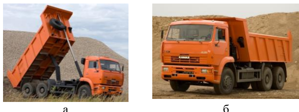
Рис. 4. Положения кузова самосвального автомобиля КамАЗ:
