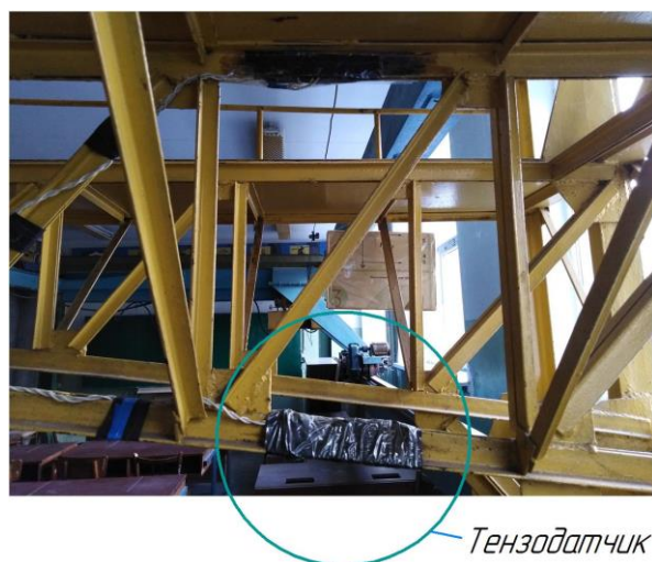
Рис. 4. Расположение тензометрических датчиков в нижнем поясе второго раскоса
