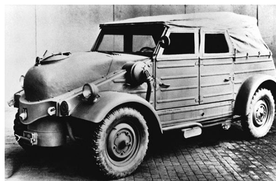
Рис. 3. Автомобиль Volkswagen Type 82 с оппозитным двигателем и газогенератором
