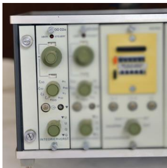
Рис. 1. Усилитель интегрирующий Robotron 00028
