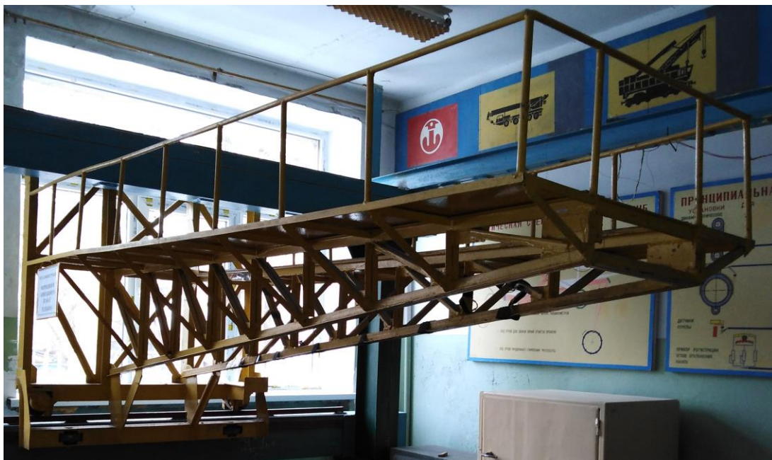
Рис. 1. Общий вид металлоконструкции консольного крана
