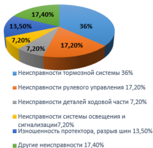
Рис. 1. Диаграмма ДТП вследствие технических неисправностей автомобиля по конструкционным особенностям
