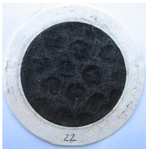
Рис. 2. Отбор сажи на фильтр типа АФА диаметром 20 мм при работе дизеля на дизельном топливе (концентрация сажи 0,238 мг/л)
