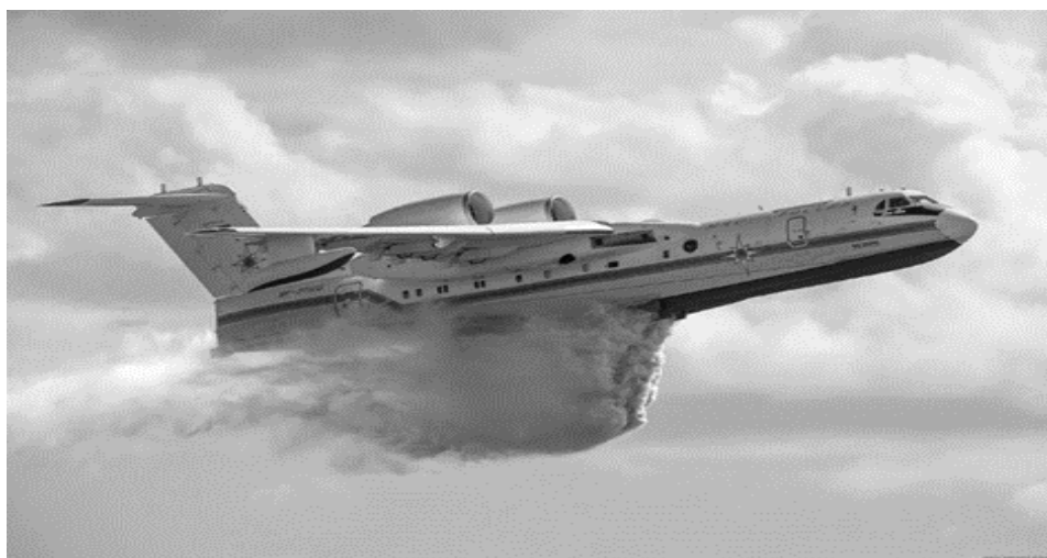
Рис. 4 Сброс воды самолётом Бе – 200ЧС
