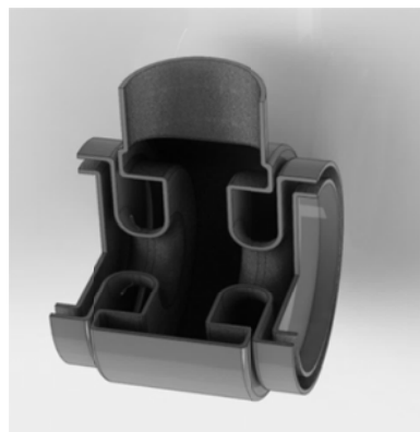
Рис. 1. Твёрдотельная модель вихревого клапана с двусторонним выходом с радиальными диффузорами и радиальным каналом питания ВК-Р-2ДР
