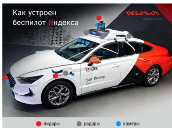
Рис. 3. Принцип работы беспилотного автомобиля Яндекс
