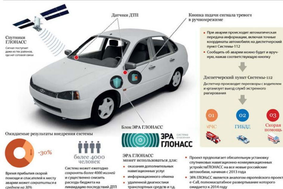
Рис. 6. Детектирование ДТП системой ГЛОНАСС
