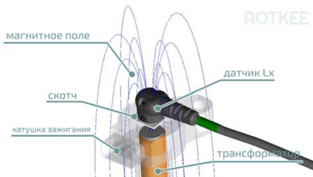
Рис. 4. Принцип действия индуктивного датчика
