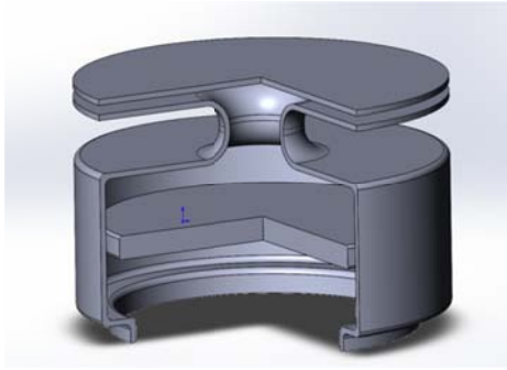
Рис.2. Твёрдотельная модель вихревого клапана с односторонним выходом с радиальным диффузором и осевым каналом питания ВК-О-ДР
