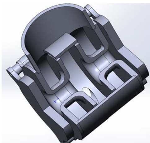
Рис.2. Твёрдотельная модель вихревого клапана с двусторонним выходом с радиальными диффузорами и осевым каналом питания ВК-О-2ДР
