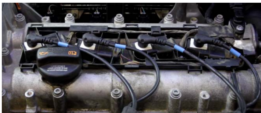
Рис. 5. Методика установки датчика на катушки зажигания
