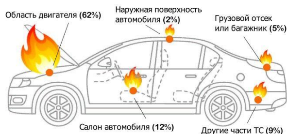
Рис. 1. Основные зоны возгорания автомобиля
