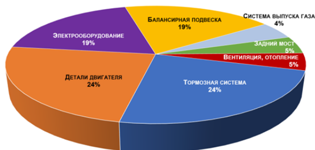
Рис. 2. Дефектные узлы автобусов(НЕФАЗ 5299-30-56; НЕФАЗ 5299-11-56) с газовым двигателем КАМАЗ 820.91-260
