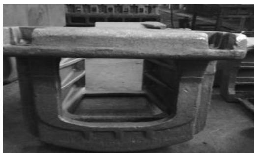
Рис. 2. Вид отливки «Упор передний, УП-1», полученная по предложенной технологии, на жидкостекольной смеси с управляемой разупрочняемостью
