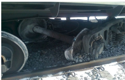
Рис. 5. Разрушения литой боковой рамы
