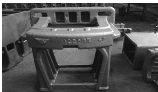
Рис. 2. Вид отливки «Упор передний, УП-1», полученная по предложенной технологии, на жидкостекольной смеси с управляемой разупрочняемостью
