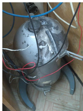
Рис.3. Детектор гамма-спектрометра и его защита
