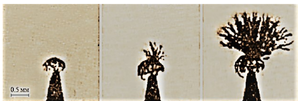
Рис. 2. Структуры разряда при микровзрывном механизме инициации
