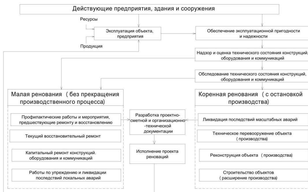
Рис. 1. Схема единой системы эксплуатации и реновации предприятий, зданий и сооружений
