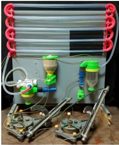
Рис. 3. Физическая модель пневмотранспортной системы
