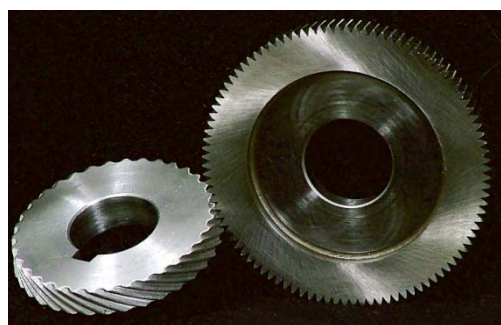
Рис. 7. Квазиглобоидное колесо с z_2 = 20 , m_n = 1,5 \text{ мм} , \beta = 60^\circ полученное прямозубым долбяком z_d = 68
