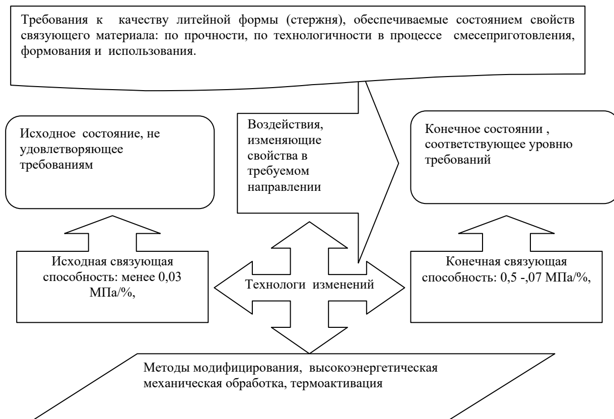
Рис. 1. Методологический подход при разработке новых литейных связующих на основе технических лигносульфонатов, отвечающих современному уровню требований
