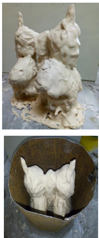
Рис. 7, 8. Облицовка модели и установка опоки
