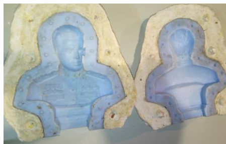
Рис.3. Силиконовая форма в гипсовом кожухе
