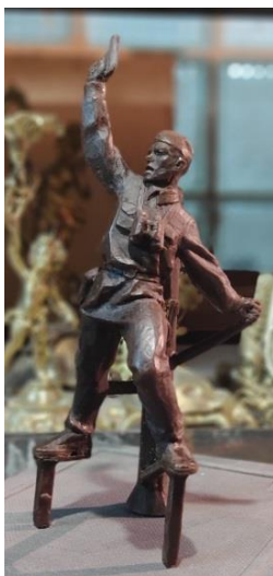
Рис. 6. Восковая модель отливки политрук с элементами литниковой системы.
