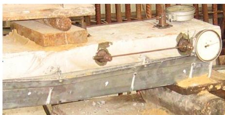
Рис. 1. Отслоение стенки настила и смятие отверстий в профнастиле в местах анкеровки в пролете в момент разрушения балки с внешним армированием
