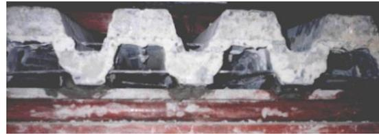
Рис. 5. Ударопрочная сталефибробетонная плита с двойным профнастилом
