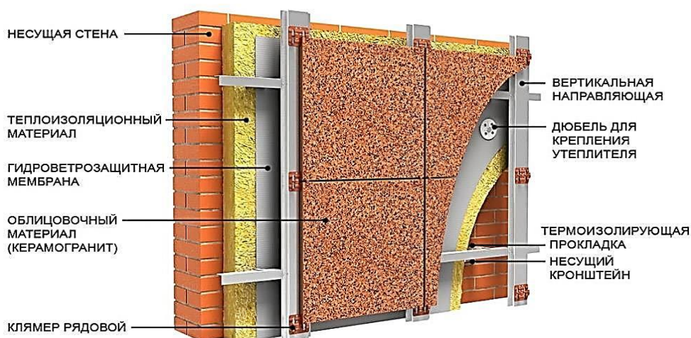
Рис. 2. Создание вентилируемого фасада
