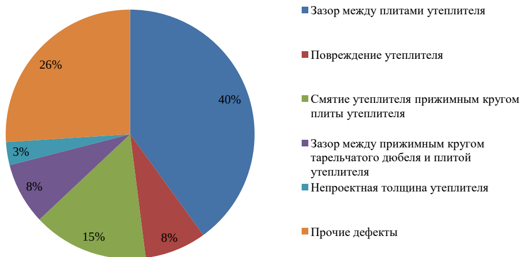
Рис. 5. Статистика дефектов стеновых фасадных систем в ЛНР и ДНР
