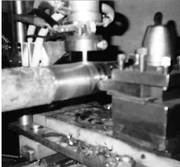
Рис. 1. Экспериментальная установка для ПМО материалов
