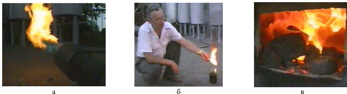
Рис. 5. Процесс сжигания: а) пиролизного газа; б) жидкой фракции пиролиза; в) пирокарбона
