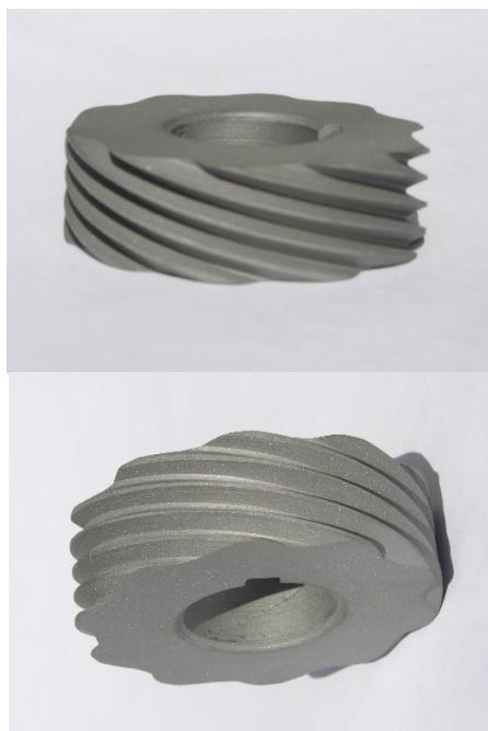
Рис. 3. Многозаходный зубчатый накатной инструмент
