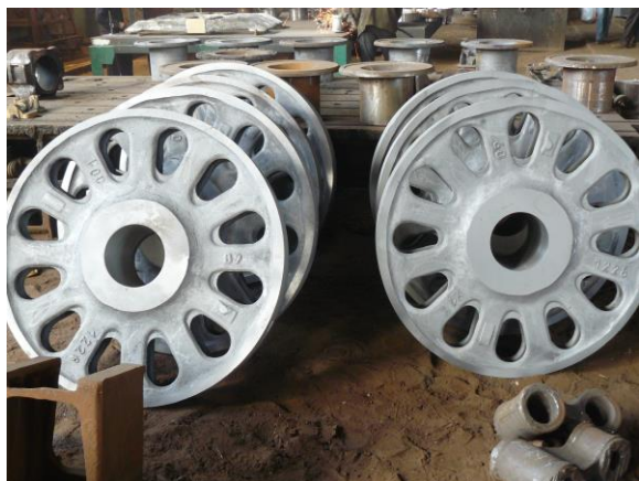
Рис 5. Внешний вид отливки «колесо», полученной по технологии в разовые песчаные формы
