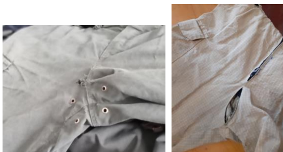
Рис. 2. Фото разрывов брюк БОП после эксплуатации
