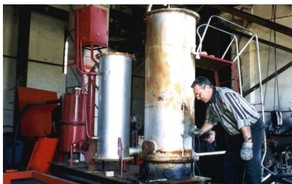
Рис. 2. Общий вид газогенератора ГГ-30
