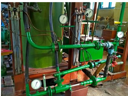
Рис. 2. Общий вид экспериментальной установки нагнетательного эрлифта с воздушоструйным компрессором
