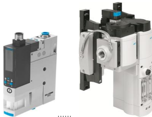
Рис. 1. Генератор вакуума со всеми встроенными функциями, включая функцию экономии воздуха (слева), и модуль энергоэффективности, прекращающий подачу воздуха при снижении расхода ниже заданного уровня
