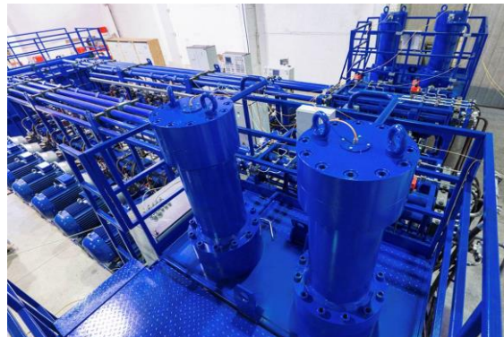
Рис. 4. Вид части насосной установки стенда с гидропреобразователями
