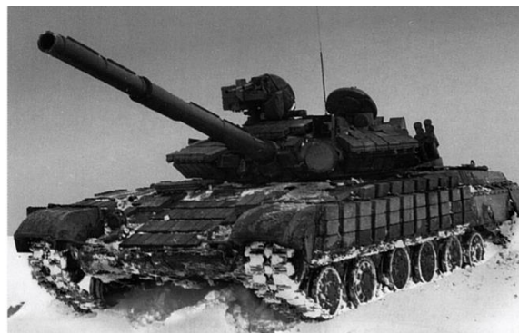
Рис. 1. Танк Т-64 БВ, оборудованный динамической защитой «Контакт-1»
