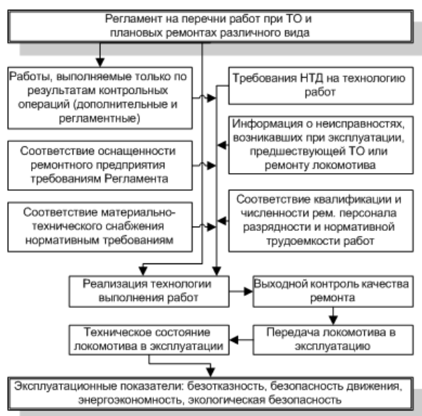
Рис. 2. Схема взаимосвязи видов обеспечения ТО и ремонта локомотивов
