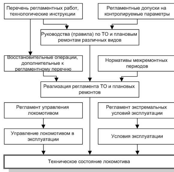
Рис. 1. Структура основных факторов, определяющих техническое состояние локомотива
