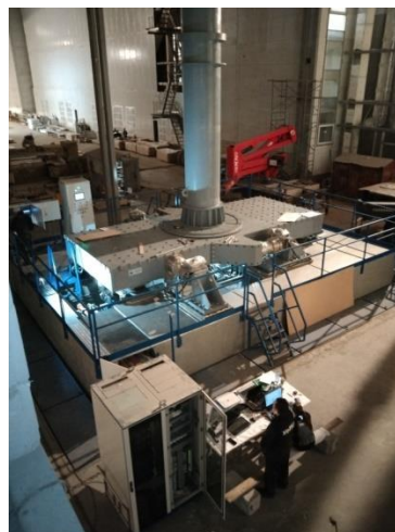
Рис. 1. Общий вид УТСВ с макетом КА, установленным на УПП, в процессе пусконаладочных работ стенда
