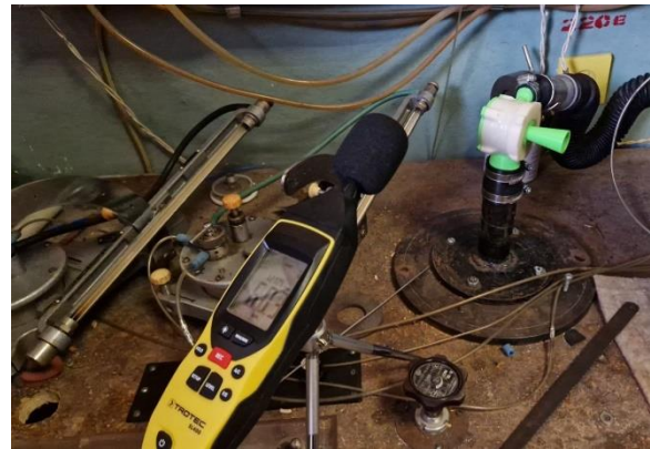
Рис. 4. Испытуемая модель вихревого клапана ВК-Р2-ДО и шумомер Trotec SL400 на экспериментальном стенде
