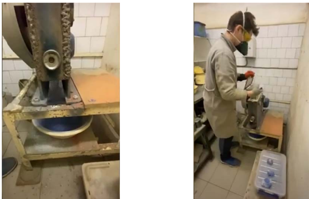
Рис. 7 Дробление пигментного сырья
