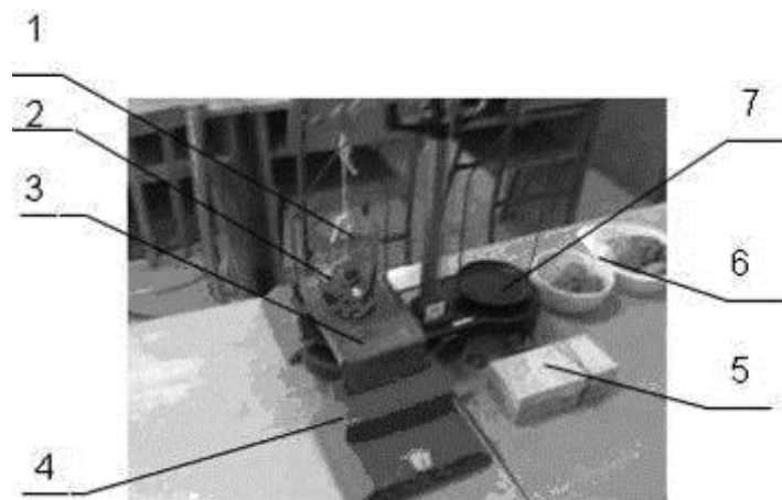
Рис. 1. Общий вид оборудования для определения плотности грунта:
