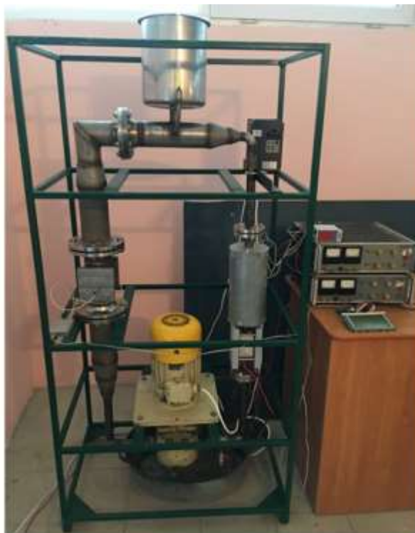
Рис. 2. Структурная схема испытательного стенда (а) для исследований характеристик СВЧ влагомера нефти и нефтепродуктов: РБ – расширительный бак; ИУ – измерительное устройство; ИП – испытуемый прибор; ТБ – блок температурной регуляции (термостатирования); НШ – шестеренчатый насос; Кш – кран шаровой и его внешний вид (б).
