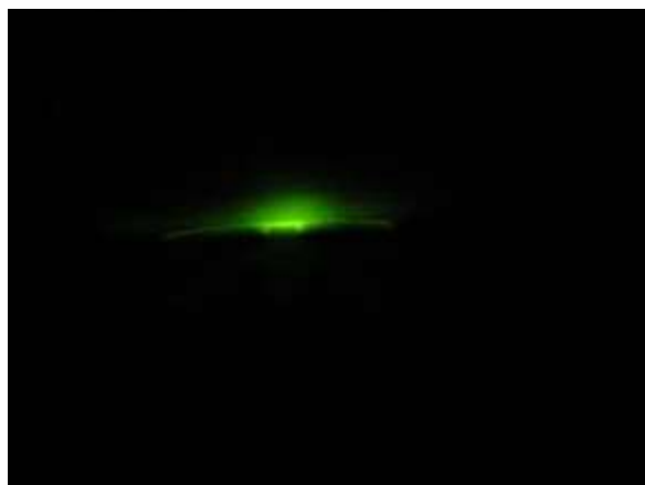
Рис.2. Светящаяся область при съемке вдоль поверхности сапфира
