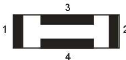
Рис. 4. Схема напыления контактов для измерения ЭДС Холла. 1, 2 – токовые контакты, 3, 4 – потенциальные контакты
