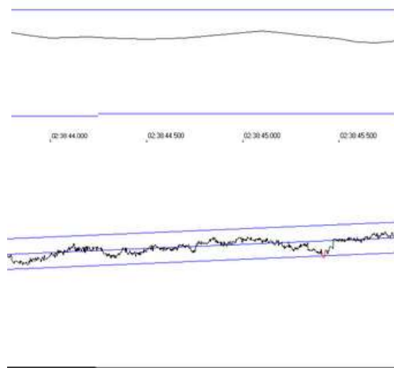
Рис.3. Примеры записи медленных движений створок моллюсков (мидий) - изменения напряжения в зависимости от деформации при нагрузке/разгрузке тензодатчика: за 1 минуту (вверху); за несколько часов (внизу)
