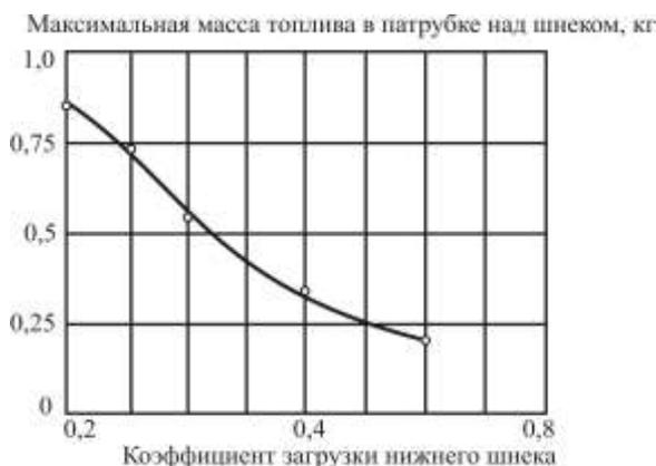
Рис. 3. Влияние коэффициента загрузки нижнего шнека на максимальную массу топлива в патрубке над шнеком
