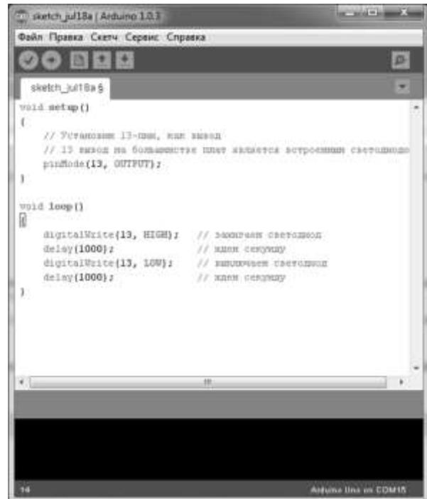
Рис. 6. Пример скетча, выполненного в среде для разработки Arduino IDE
