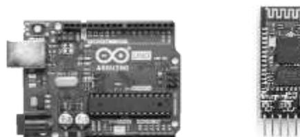
Рис. 3. Arduino и Bluetooth модуль HC-05
