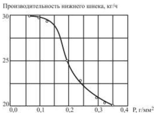
Рис. 5. Влияние давления топлива на шнек (P) на производительность питателя транспортного газогенератора с пеллетной горелкой при коэффициенте объемного заполнения шнека  $\psi = 0,25$
