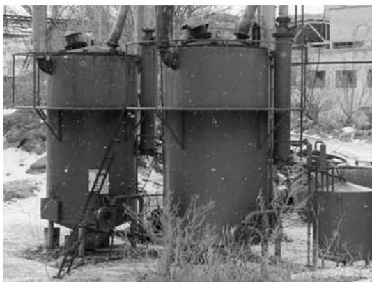
Рис. 1. Установки Fortan 4 по переработке промышленных отходов
