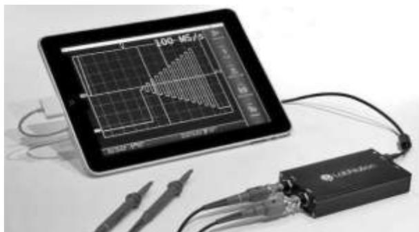
Рис. 3. Внешний вид цифрового осциллографа на базе ПК
