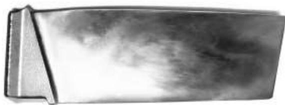
Рис. 4. Обработка лопатки с визуализацией контролируемых цветов покрытий
