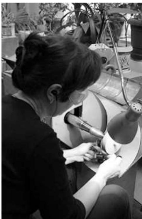
Рис. 5. Ремонт лопатки компрессора с остатками нитрид титановых покрытий
