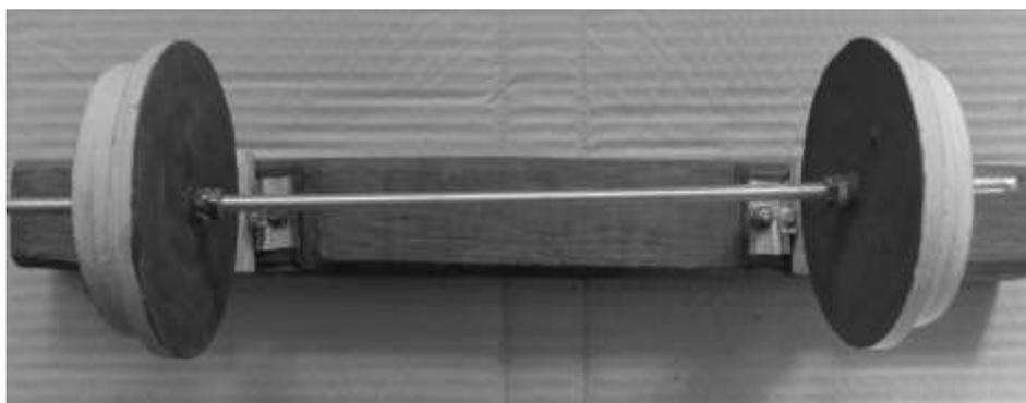
Рис. 9. Макет шпалы универсальной с установленной колесной парой
