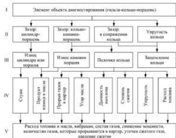
Рис. 1. Структурно-наследственная диагностическая модель цилиндра-поршневой группы двигателя
