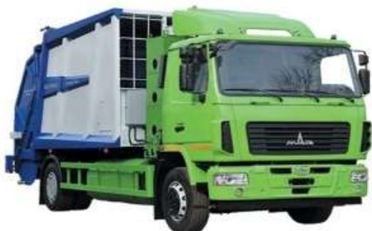
Рис. 2. Мусоровоз МАЗ «Сафир-Эко» (газовый двигатель ЯМЗ-53644) [5]
