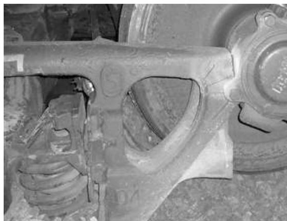
Рис. 1. Изломы боковых литых рам тележек типа 18-100 эксплуатирующихся грузовых вагонов
