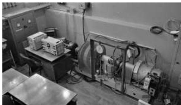
Рис. 4. Общий вид стенда для испытания тормозных устройств
