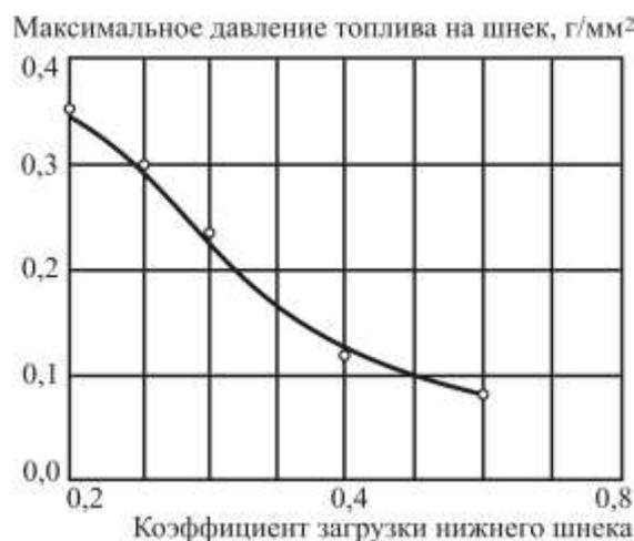
Рис. 4. Влияние коэффициента загрузки нижнего шнека на максимально допустимое давление топлива на шнек
