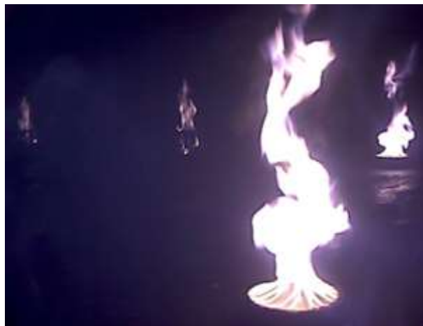
Рис. 4. Одновременное тушение пожаров классов А и В в испытательном помещении №1
