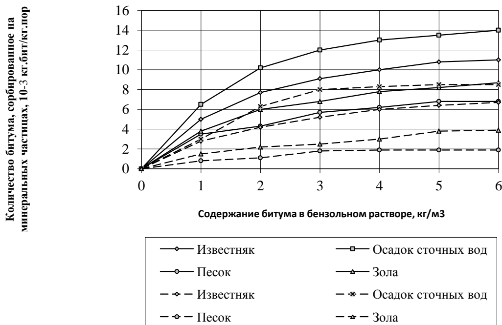
Рис. 1. Зависимость количества битума, сорбированного на минеральных частицах, от содержания битума в бензольном растворе: ——— - первоначальная адсорбция битума на поверхности; - - - - - после десорбции бензолом
