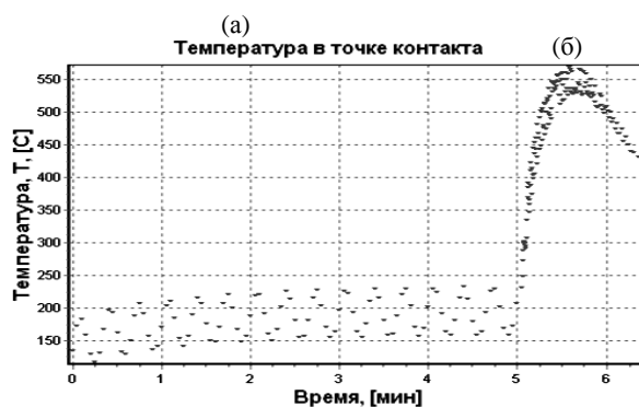
Рис. 2. Характеристики теплового потока зоны контакта: а) – температурный режим постоянного хода; б) – температурный режим остановочного торможения со скорости 120 км/ч С-С колодками [6] при усилии нажатия вагонных и локомотивных колодок соответственно 10 кН и 20 кН
