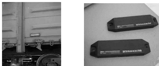
Рис.2. Крепление бортовых датчиков (метки) на вагонах
