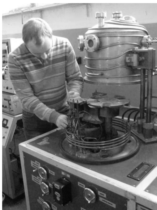
Рис. 4. Установка для термического испарения в вакууме и газовой среде
