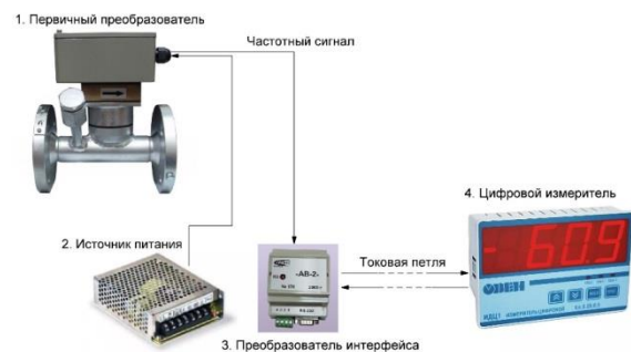
Рис. 3. Разработанная схема канала измерения расхода греющего газа
