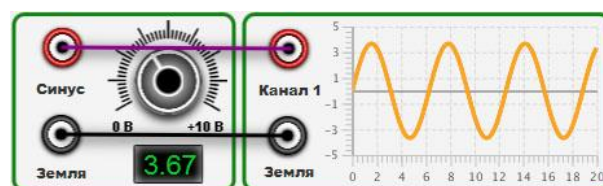
Рис. 1. Часть приборной панели виртуального лабораторного стенда «Теория электрической связи» с проводными соединениями соответствующих разъемов
