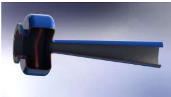
Рис. 1. Модель вихревого клапана с осевым каналом питания и осевым диффузором на выходе.
