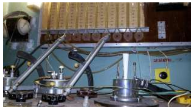
Рис. 8. Внешний вид экспериментальной установки для моделирования течения несжимаемой жидкости (воздуха) в вихревых клапанах
