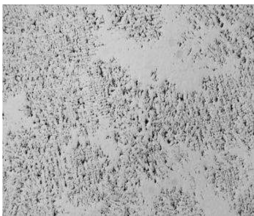
Рис. 2. Микроструктура образца СЧ-35, полученного при индукционной плавке
