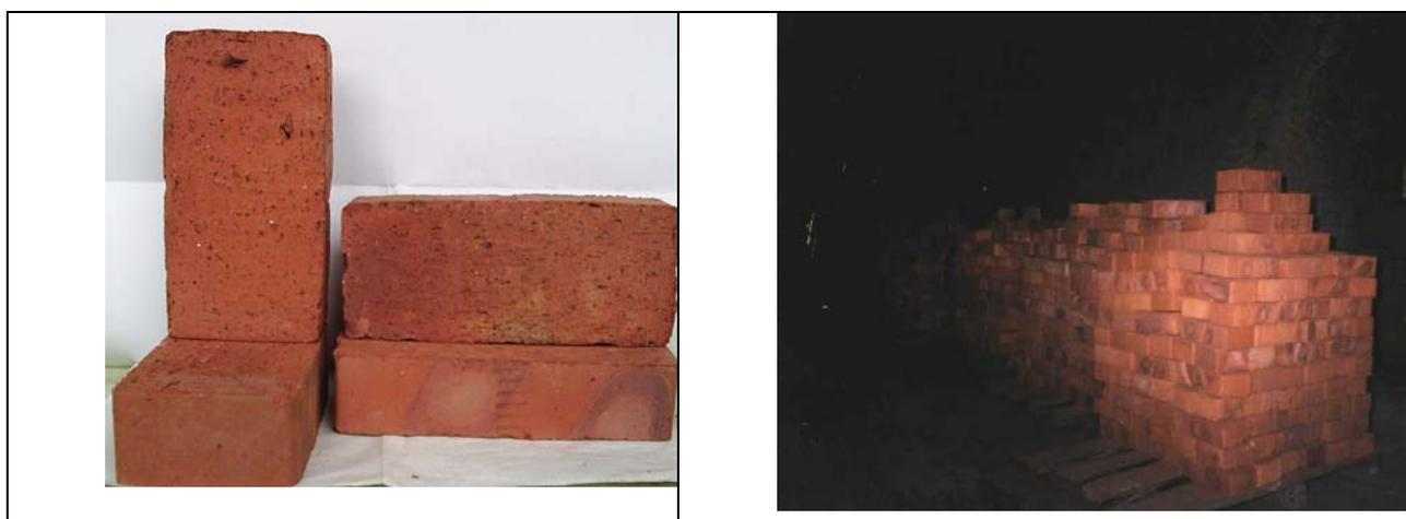
Рис.6. Производство керамических изделий на основе ОСВ (лабораторный образец и опытная партия)
