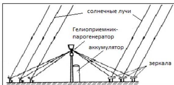
Рис. 3. Схема работы Крымской экспериментальной СЭ
