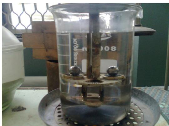
Рис. 1. Определение температуры размягчения (кольцо и шар)
