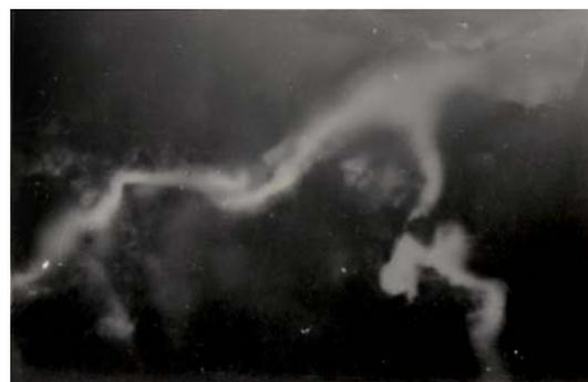
Рис. 2. Поровые каналы цементного камня бетона, заполненные продуктами флюатирования (светлая область). Увеличение × 500
