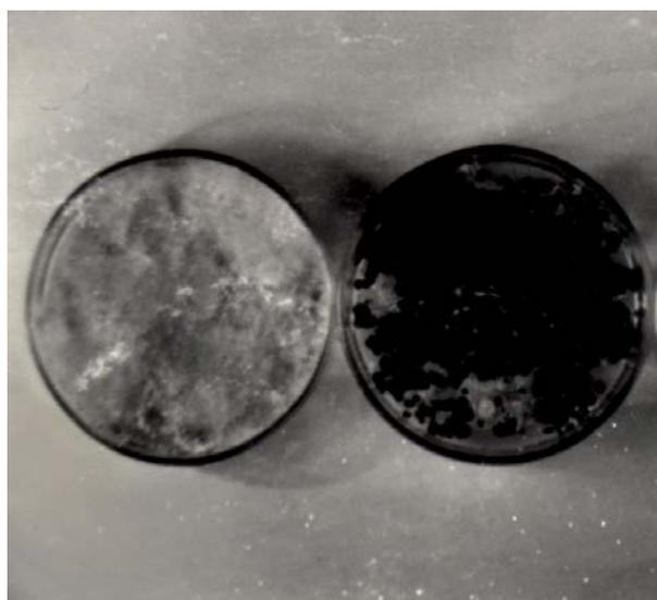
Рис. 5. Чашки Петри с выделенной культурой грибов с поверхности нефлюатированного бетона (слева) и отсутствием грибного заражения на флюатированном образце (справа)
