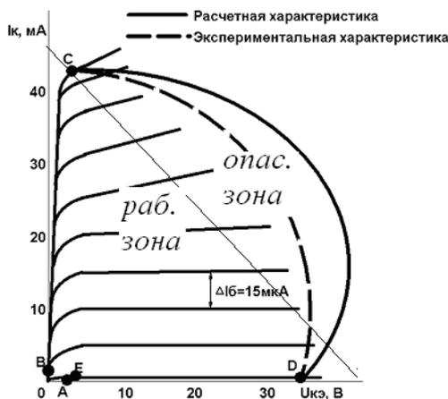
Рис. 2. Статические и динамические характеристики для транзистора в схеме ключа с LR-нагрузкой
