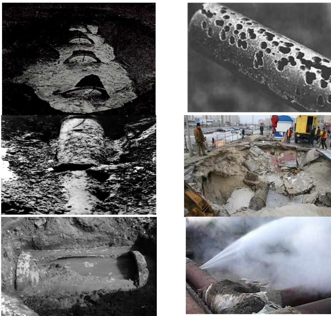
Рис. 4. Виды отказов коммунальных трубопроводов
