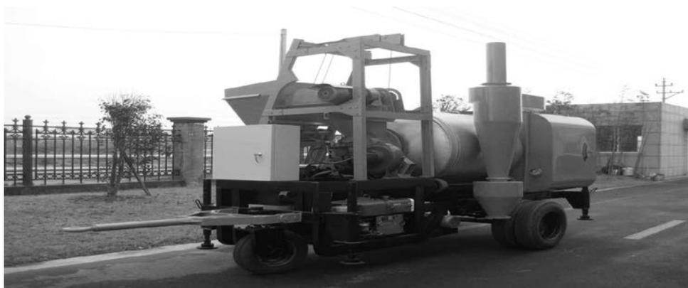
Рис. 4. Мини – АБЗ производительностью 3 т/час
