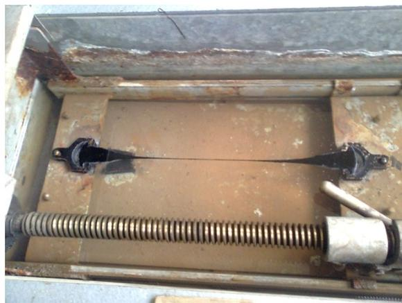
Рис. 2. Определение растяжимости
