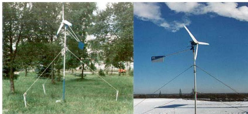
Рис. 8. Внешний вид малой ВЭС с крылом-стабилизатором
