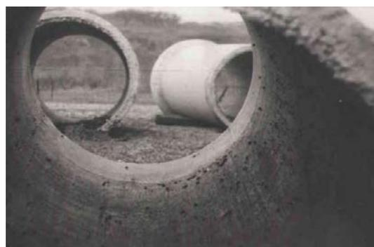
Рис. 1. Заводские и транспортные дефекты ж/б труб
