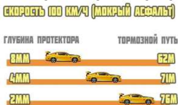
Рисунок 2.2 – Зависимость тормозного пути от глубины протектора
